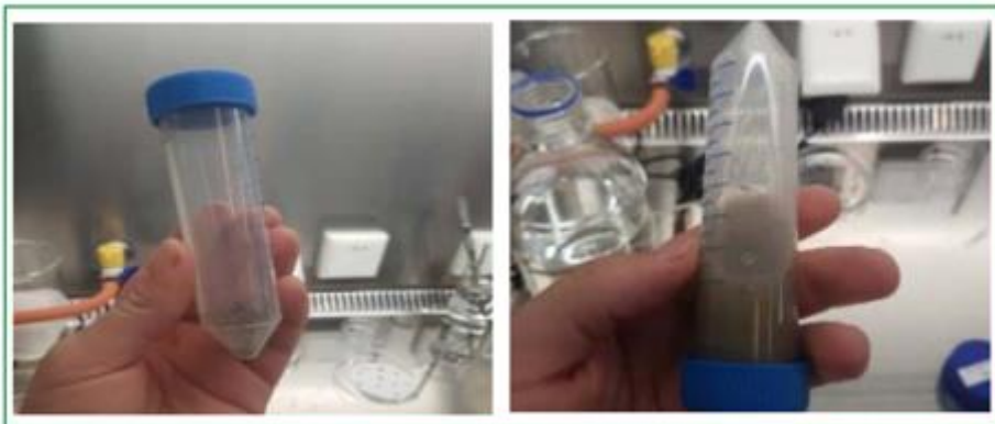
Figura 13. Manejo de las muestras de suelo en el laboratorio y dilución de la muestra.
