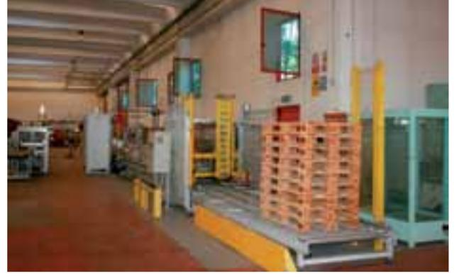
تسمح العملية المستمرة (الصورة في اليمين) بسرعة ثابتة بمعالجة المنصات الخشبية. ويمكن قياس تحقيق متطلبات الحرارة بصور الأشعة تحت الحمراء لتقويم درجات حرارة السطح.
