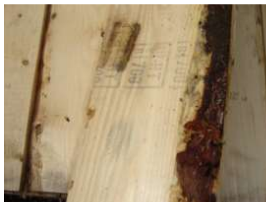
Imagen 2 – Corteza al borde de una tabla mide menos de 3 cm de ancho, por ende, la tabla cumple con los niveles de tolerancia de corteza.
