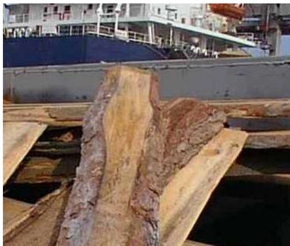
Imagen 6 – Corteza excede los niveles de tolerancia. La corteza debe eliminarse o el trozo no podrá utilizarse en el embalaje de madera.
