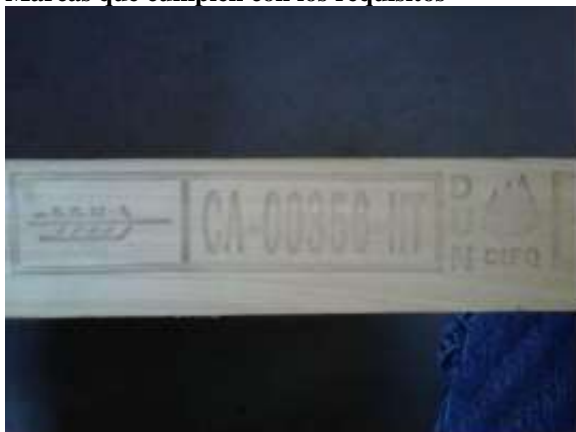
Imagen 1 4 – Marca concuerda con el ejemplo 6 del Anexo 2 de la NIMF 15. Se incluye información adicional fuera de los bordes de la marca.
