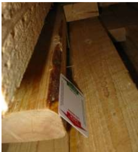
Imagen 5 – Corteza al borde mide más de 3 cm y el trozo de madera de estiba mide más de 50 cm 2 . La madera de estiba destinada al barco no cumple con los requisitos
