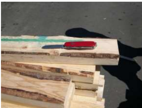
Imagen 3 – Corteza en el extremo de la tabla. La navaja mide 2 cm por 15 cm, por ende, la tabla cumple con los niveles de tolerancia. La tabla debajo de la que tiene la cuchilla, solo presenta arista faltante (cámbium decolorado) y por ende cumple con los requisitos.
