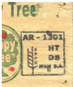
Imagen 3 6 – Orientación de la información no concuerda con los ejemplos del Anexo 2 de la NIMF 15. La información que se encuentra dentro de los bordes de la marca excede los requisitos.
