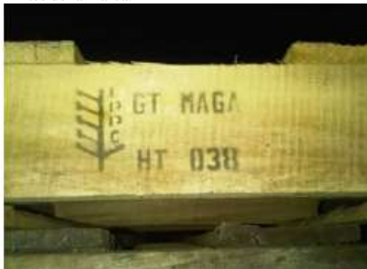
Imagen 4 6 – Marca no contiene bordes necesarios.
