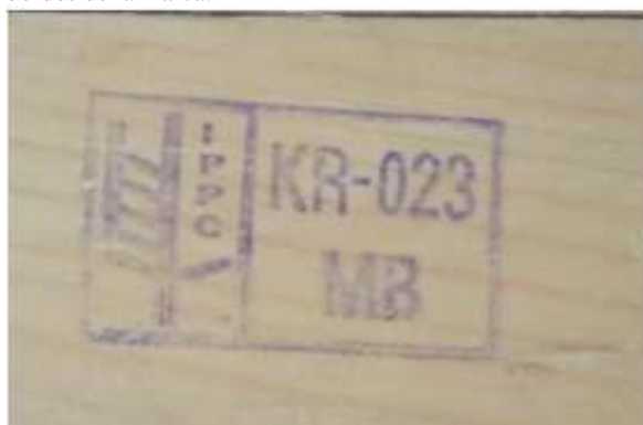
Imagen 3 6 – Marca concuerda con el ejemplo 1 del Anexo 2 de la NIMF 15.
