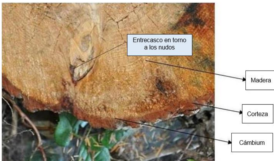
Figura 2. Sección transversal de madera en rollo.
