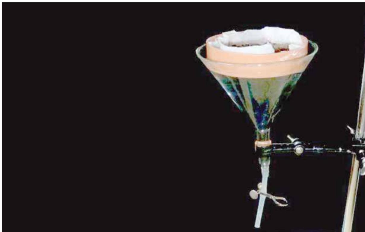
Рисунок 16. Модифицированная воронка Бермана для выделения нематод из растительного материала или почвы
