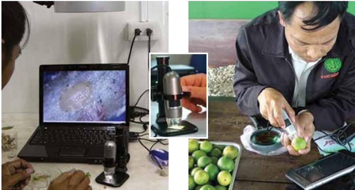
**Рисунок 29.** Слева: В пункте досмотра на границе с USB-микроскопа на ПК передаются изображения, которые могут просматривать удаленные специалисты посредством инструментов взаимодействия через интернет, таких как Skype. Центр: USB-микроскоп с 20–200-кратным увеличением. Справа: Пограничный инспектор изучает вредные организмы и создает изображения, используя USB-микроскоп
